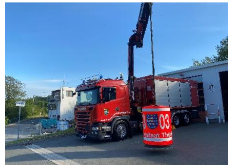
WLF 26 Kran mit Außenlastbehälter (900l) am Standort der TLFKS Bad Köstritz
